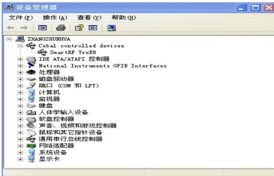
或者通过 Smart RF Studio 可以检测到该接入的 Demo 板。下图中设备列表里已显示出该 Demo 板，并且能检测到 CC1120 芯片。
